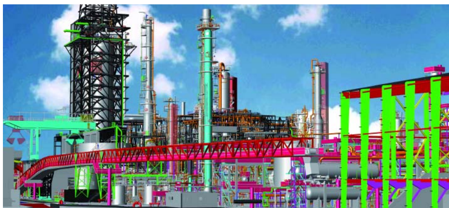
Vista de la cinta tubular cerrada que transportará el coque a la nave de almacenamiento.
