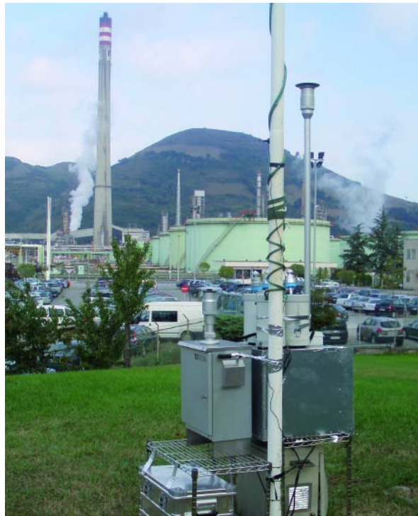
Uno de los equipos de captación de polvo en suspensión instalados en las proximidades de las obras.
