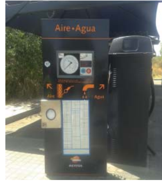
Poste suministro aire y agua.
